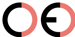
Falsche CE-Kennzeichnung (zu großer Zwischenraum)
